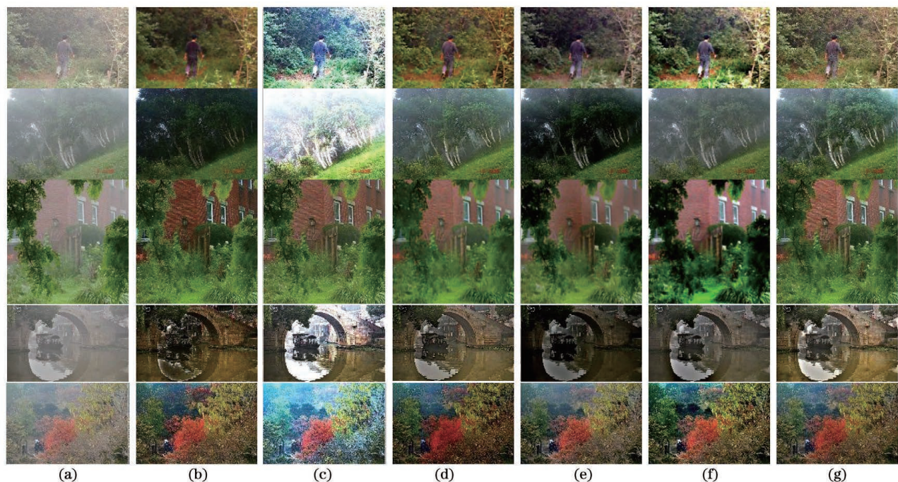
图 9 不包含天空的雾图复原结果。(a)有雾图像;(b)He 等的结果;(c)Meng 等的结果;(d)Yang 等的结果;(e)Cai 等的结果;(f)Ren 等的结果;(g)本文结果
