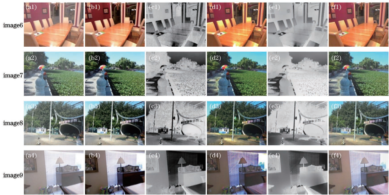
图 4 利用不同模型得到的合成雾图复原结果的分析。(a1)~(a4)雾图;(b1)~(b4)清晰图;(c1)~(c4)利用文献[5]中模型获得的透射率;(d1)~(d4)利用文献[5]中模型获得的复原结果;(e1)~(e4)利用所提模型获得的透射率;(f1)~(f4)利用所提模型获得的复原结果
