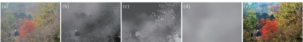
图 7 所提算法去雾示意图。(a) 有雾图像;(b) 雾度分布;(c) 透射率;(d) 大气光;(e) 去雾图像
