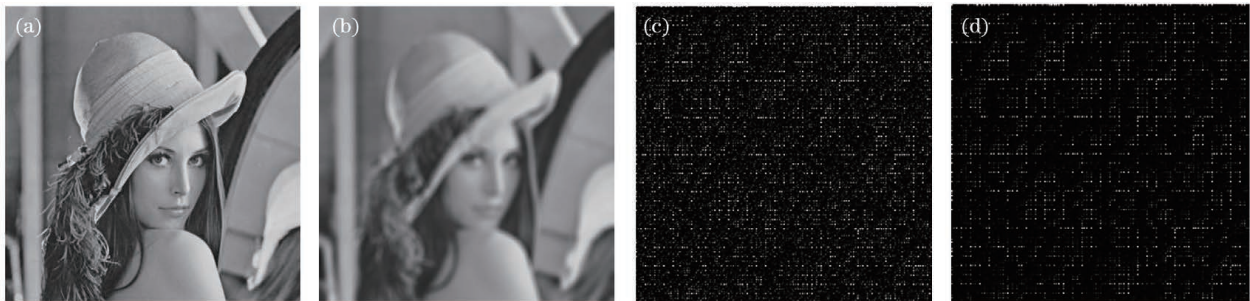
图 1 清晰图像和模糊图像及其 DWHT 变换结果。(a) 清晰图像; (b) 模糊图像; (c) DWHT of Fig. 1(a); (d) DWHT of Fig. 1(b)
