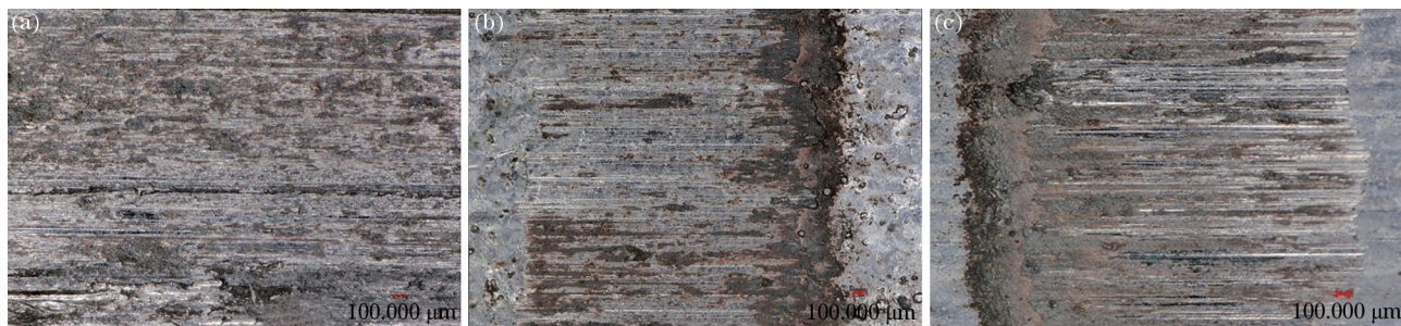
图 8 超景深显微镜下的磨损形貌。(a)基体;(b)熔覆层;(c)重熔层
