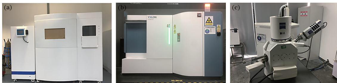
图 3 本次实验所用设备。(a) SLM 打印机; (b) 工业 CT; (c) 扫描电子显微镜
