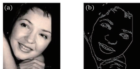
图 4 基于Canny算子提取的人脸边缘特征。(a)人脸图像;(b)人脸边缘
