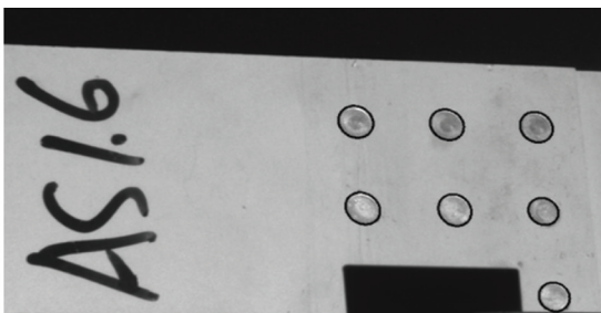
图 7 图 2 所示蒙皮图像中铆钉轮廓的提取结果 Fig. 7 Rivet contour extraction result corresponding to the skin image shown in Fig. 2
