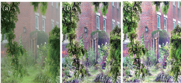
图 2 MSR 去雾结果与 MSR 去雾后亮度增强结果对比图。(a)原图；(b)MSR 去雾图；(c) 增强后的 MSR 去雾图
