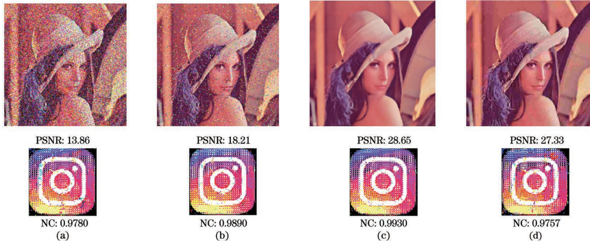
图 7 非几何攻击下的 Lena 图和检测结果。(a)高斯噪声(0.05);(b)椒盐噪声(0.05);(c)中值滤波(7×7);(d)JPEG 压缩(10%)
