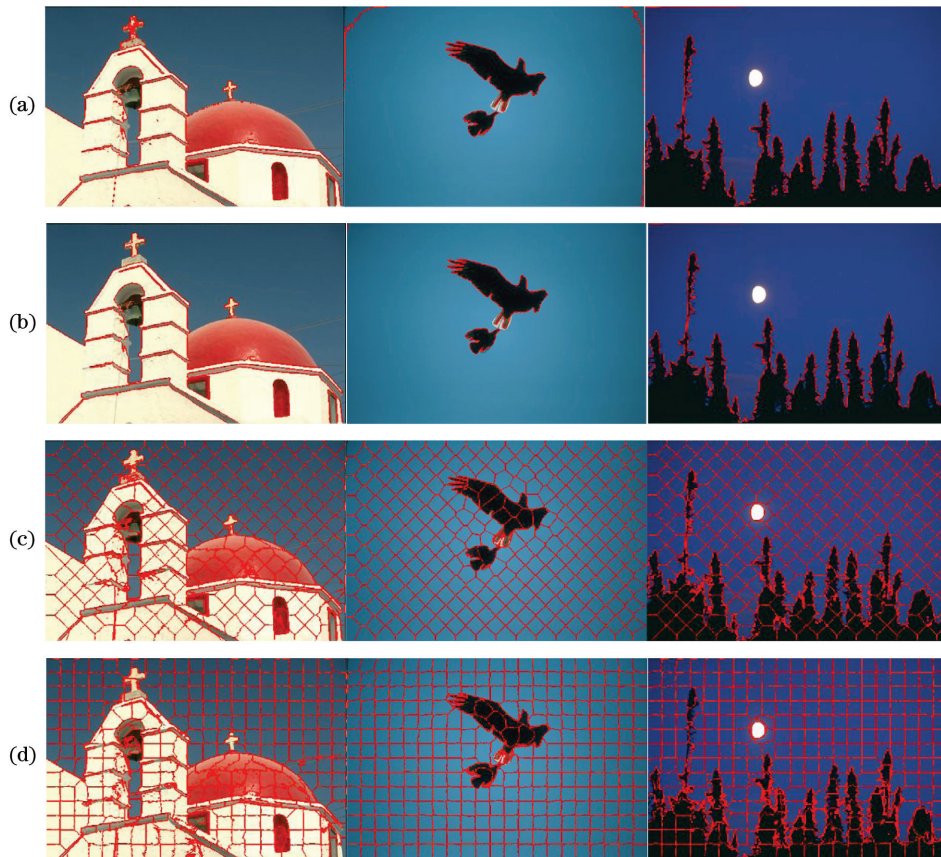
图 2 算法各环节下的结果对比。(a)本文算法划分结果;(b)本文算法划分后第一次合并结果;(c)本文算法聚类结果;(d)SLIC 算法聚类结果
