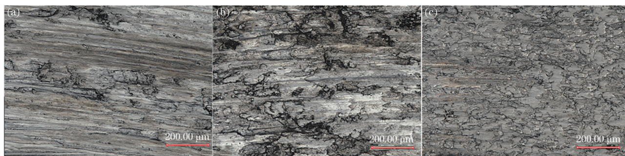
图 10 不同扫描速度下熔覆层磨损形貌。(a) v=5\text{ mm/s} ; (b) v=6\text{ mm/s} ; (c) v=7\text{ mm/s}
