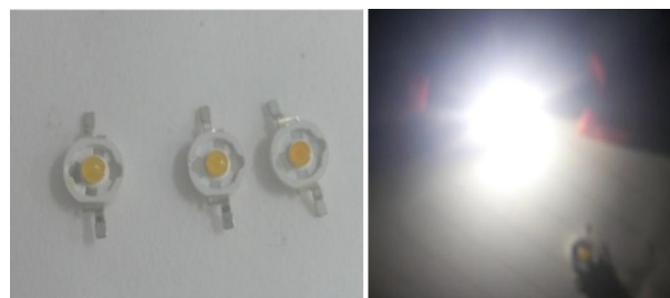
图 1 三种不同比例的量子点白光 LED 实物结构图以及量子点白光 LED 发光图
