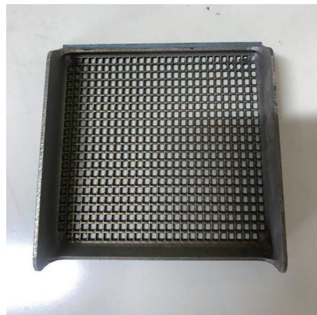
图 7 SLM 成形的格栅实物图
