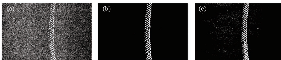
图 6 不同波长下的图像阈值分割结果。(a)406 nm 波段图像;(b)566 nm 波段图像;(c)645 nm 波段图像
