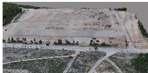
图 4 基于倾斜摄影构建的真 3D 模型 Fig. 4 True 3D model based on tilt photography
