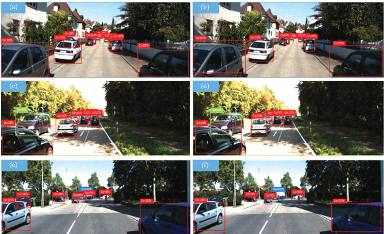
图 7 改进的 YOLOv3 与原始 YOLOv3 的检测对比。(a)(c)(e)改进的 YOLOv3; (b)(d)(f) YOLOv3
