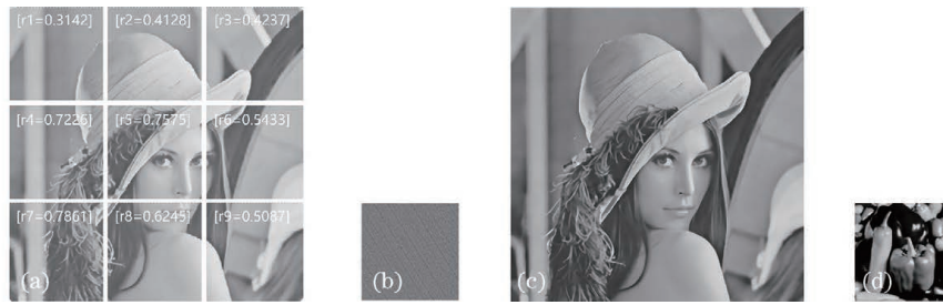
图 5 嵌入/提取后载体和信息比对情况。(a)带灰度关联序的均分载体图像；(b)置乱后信息图像；(c)隐藏信息载体；(d)提取+逆变换后的信息图像 C_N=0.9993
