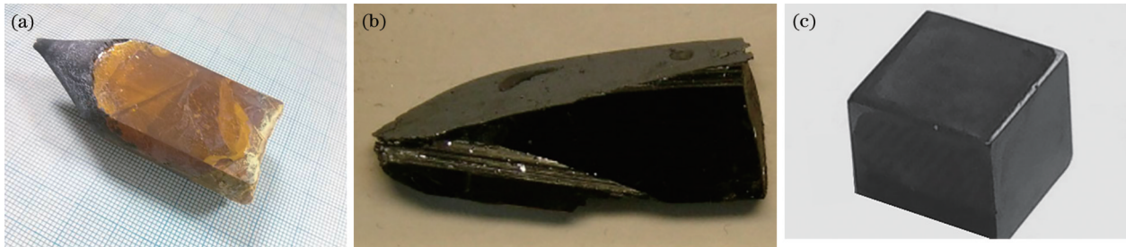
图4 三种新型声光晶体材料。(a) TlInS 2 ; (b) TlInSe 2 ; (c) InI
