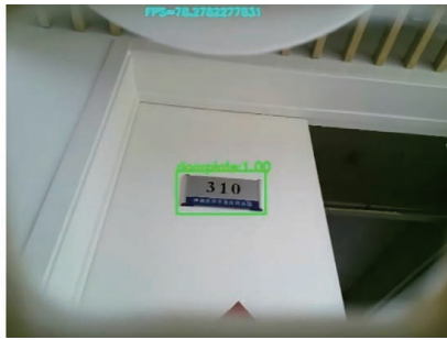
图 10 基于 MobileNet-SSD 的门牌区域检测结果 Fig. 10 Doorplate area detection result based on MobileNet-SSD
