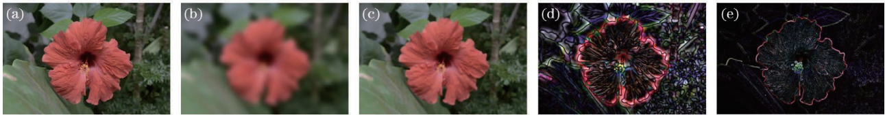
图 1 交叉分解示例。(a)输入图像;(b)基本层(高斯滤波结果);(c)双边滤波结果;(d)边界层;(e)细节层
