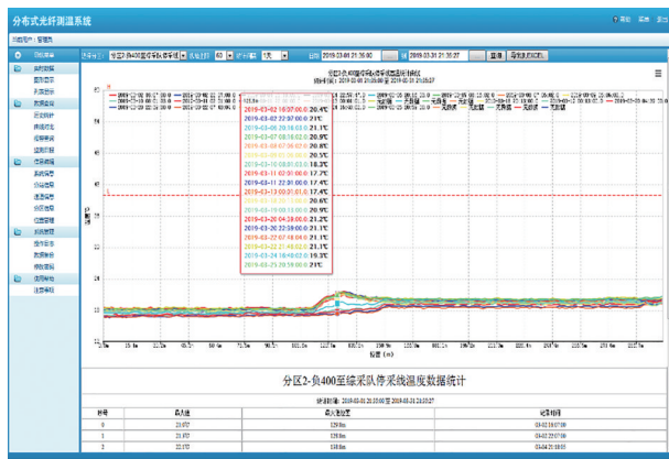
图10 2019年3月在中国东北地区某煤矿成功对采空区进行热点检测定位的数据
