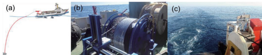
图 2 温深链设备 [31] 。(a) 630 m 拖曳链系统示意图; (b) 绞车及排缆器; (c) 拖曳中的温深链
