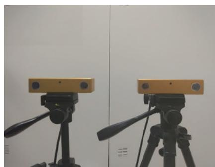
图 2 本课题组所使用的平行式多视点光学定位系统
