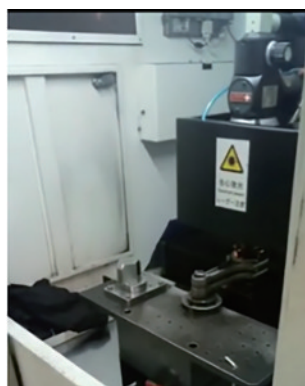
图9 LFS150胀断连杆激光切槽设备 [25-26]
