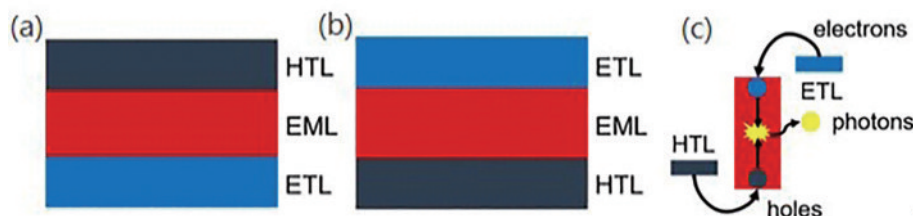
图 1 PeLEDs 结构与工作机制图 [31] 。(a) 倒置结构 (n-i-p); (b) 正置结构 (p-i-n); (c) 两种结构的运行机理
