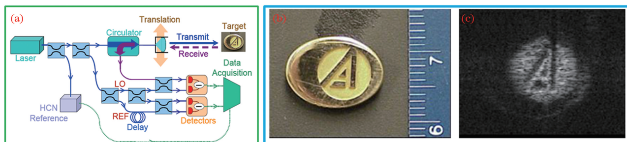
图 2 美国空军实验室 SAIL 原理验证结果 [5] 。(a)实验系统方案;(b)靶标; (c)成像结果
