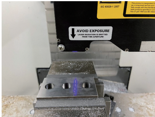
图 9 线激光扫描基准面
