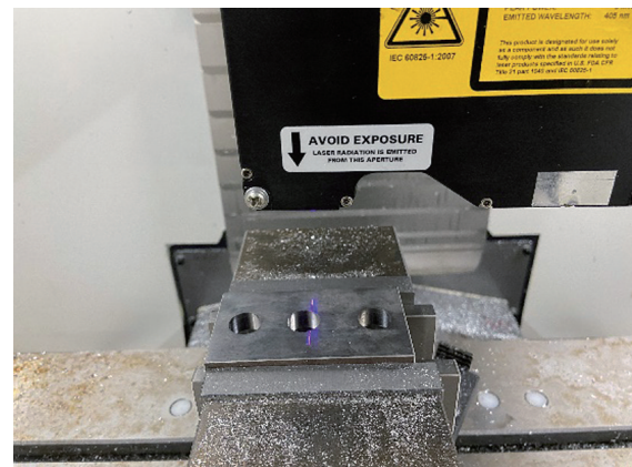
图 11 试验件角向偏差检测
