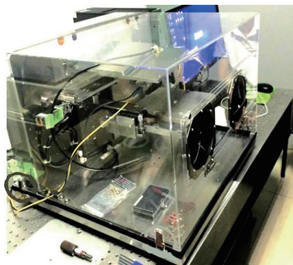
图3 TAS7500SU太赫兹时域光谱系统实物图
