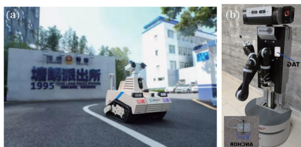
图 19 安防机器人。(a)装载激光雷达的智能巡检机器人 [52] ; (b) Orby-One 跟踪机器人 [53]
