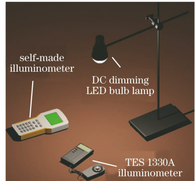
图 7 明视觉照度传感器测量误差分析原理图
