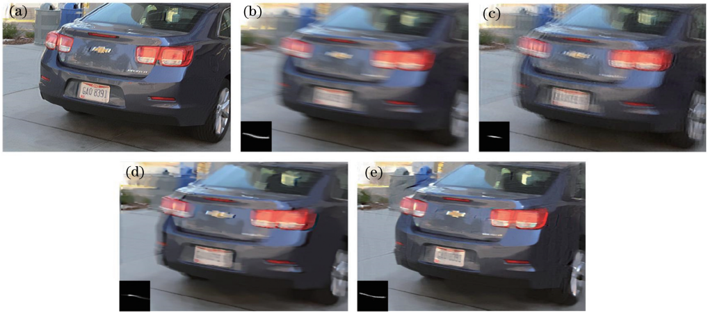
图 4 模糊图像 blue car 盲复原效果对比。(a)清晰图像;(b)模糊图像;(c)文献[9]算法的复原效果;(d)文献[14]算法的复原效果;(e)本文算法的复原效果
