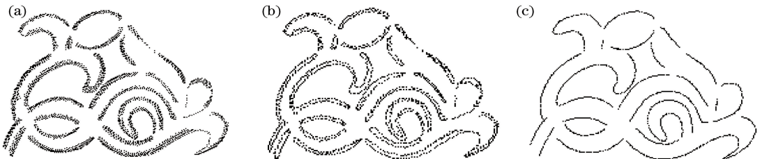
图11 皮带头下边界提取过程。(a)皮带头零件特征点;(b)特征点的边界点;(c)特征点的下边界点
