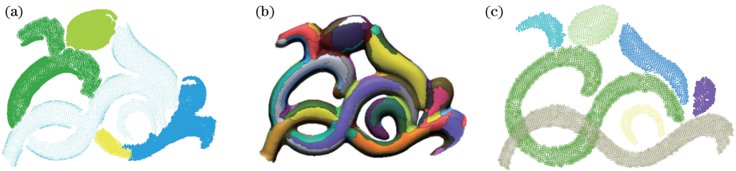
图 12 点云数据分块效果对比。(a)利用文献[4]中方法分割后的点云;(b) Geomagic Designx 分割后的点云;(c)本文算法分割后的点云
