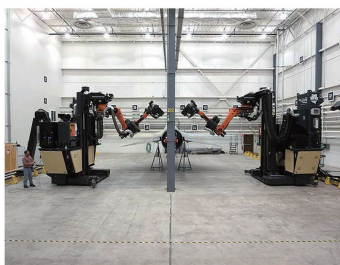
图9 ARLCRs对F-16战斗机进行激光除漆过程 [58]
