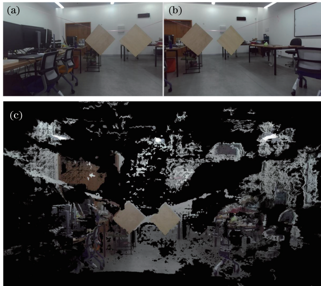
图 7 双目相机两个不同视角的点云融合。(a)(b)两个视角的左视图;(c)点云融合结果
