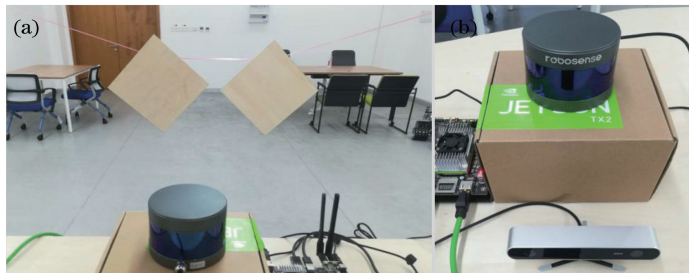
图3 实验装置图。(a)木板设置图;(b)激光雷达与双目相机放置图
