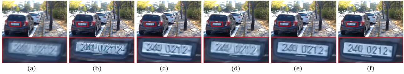
图9 不同子网在 GOPRO 测试集上的视觉效果。(a)模糊输入;(b) w/o content、(c) w/o edge、(d) w/o adv、(e) w/o PNet 和(f)本文方法的结果
