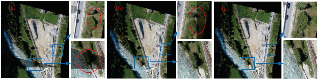
图 17 三种融合算法对不同高度图像的结果对比。(a)渐进渐出加权融合算法;(b)文献[16];(c)所提算法
