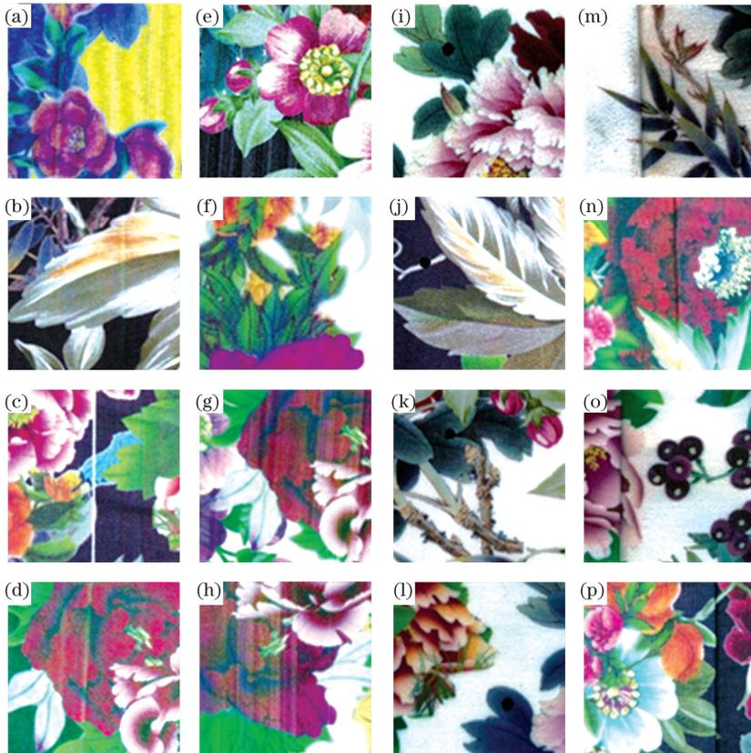
图 8 数码印花缺陷数据集样本。(a)~(d) PASS 道;(e)~(h)喷墨不均;(i)~(l)漏墨;(m)~(p)布匹褶皱
