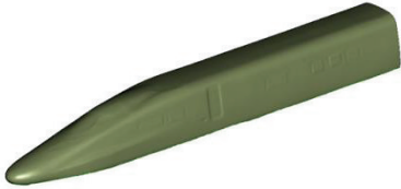
图 1 重构的机车曲面三维模型
