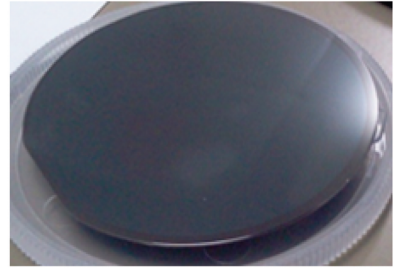
图 1 外延生长的 GaSb 薄膜
