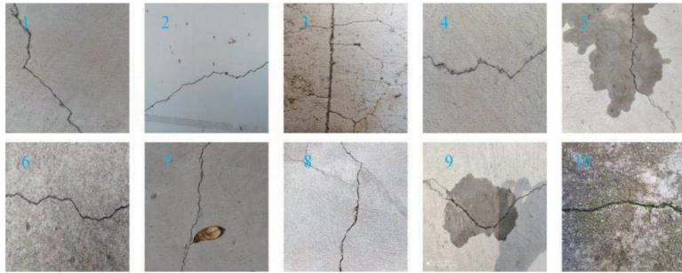
图 13 用于量化计算的裂缝原始图像
