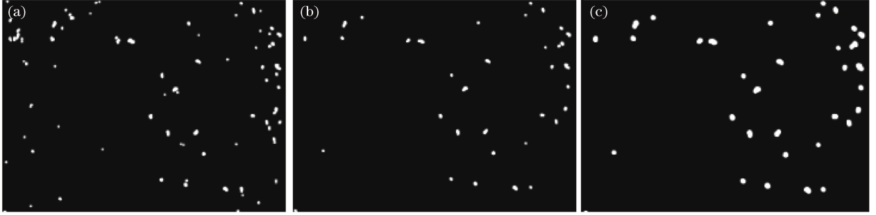
图 5 数学形态图。(a)二值化图像;(b)开闭运算重建图;(c)孔洞填充
