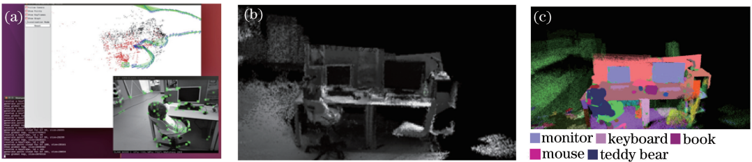
图8 语义地图验证。(a)系统实时运行;(b)原始地图;(c)语义地图
