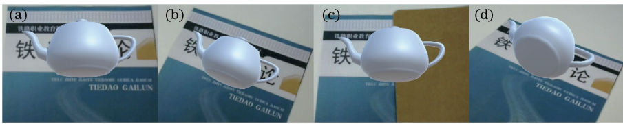
图 10 图像 B 的识别注册。(a)正面注册;(b)距离、旋转变化注册;(c)遮挡注册;(d)视角变化注册
