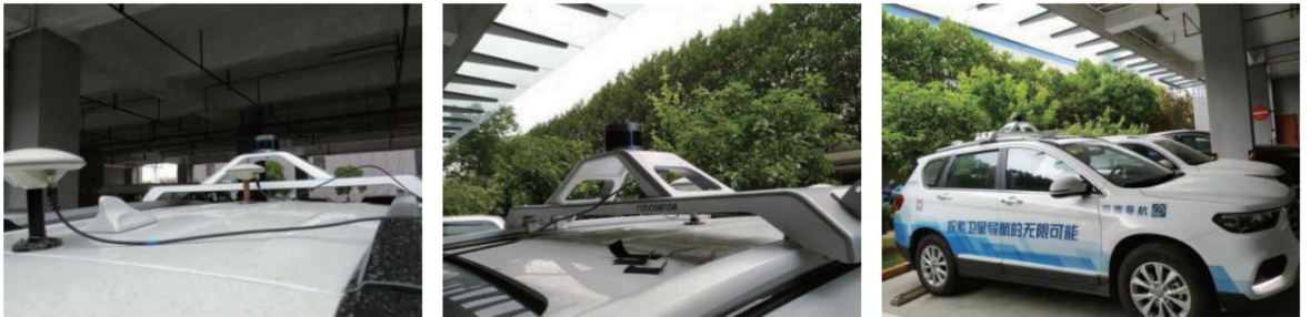
图 6 激光雷达安装及实验设备
