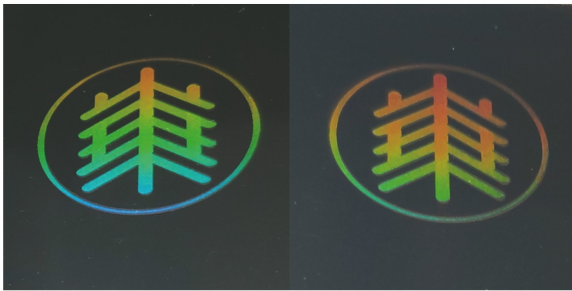
图 11 镜面抛光不锈钢表面校徽图案光学照片
