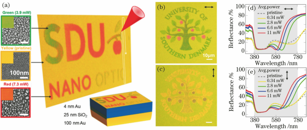
图 11 等离子激元近渗膜阵列反射器示意图 [22] 。(a) 金-二氧化硅-金结构加工示意图和不同颜色金纳米颗粒的电镜图；(b)(c)水平、竖直偏振光加工的样品图；(d)(e)不同功率的水平、竖直偏振光加工样品的反射光谱
