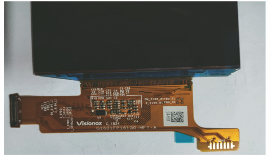
图 8 RGB-Delta 结构 AMOLED 模组 Fig. 8 RGB-Delta AMOLED module
