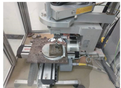
图 4 残余应力测试平台
