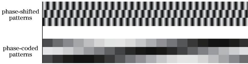
图 3 光栅投影测量系统中使用的光栅图像
