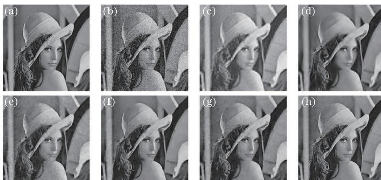
图5 不同算法下图像 Lena的降噪结果。(a)图像 Lena;(b)噪声图像;(c) DWT算法;(d) CNC算法;(e) NLM算法;(f) BM3D算法;(g) EPLL算法;(h)本文算法
